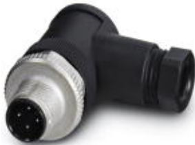
Sensor-/Aktor-Stecker, Stecker, gewinkelt, 4-polig, M12, A-kodiert, Schraubanschluss, Metallrändel, Kabelverschraubung Pg7
