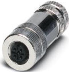
Sensor-/Aktor-Stecker, Buchse, gerade, 5-polig, M12 geschirmt, A-kodiert, Schraubanschluss, Metallrändel, Kabelverschraubung Pg7
