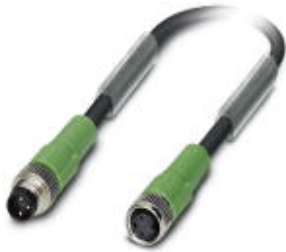
Sensor-/Aktor-Kabel, 3-polig, PUR halogenfrei, schwarzgrau RAL 7021, Stecker gerade M8, auf Buchse gerade M8, Kabellänge: 0,6 m
