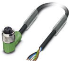
Sensor-/Aktor-Kabel, 5-polig, PUR halogenfrei, schwarzgrau RAL 7021, freies Leitungsende, auf Buchse gewinkelt M12, A-kodiert, Kabellänge: 1,5 m
