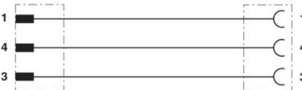
Kontaktbelegung der M8-Stecker/Buchse
