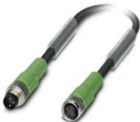
Sensor-/Aktor-Kabel, 3-polig, PUR halogenfrei, schwarzgrau RAL 7021, Stecker gerade M8, auf Buchse gerade M8, Kabellänge: 0,3 m
