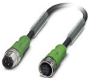
Sensor-/Aktor-Kabel, 4-polig, PUR halogenfrei, schwarzgrau RAL 7021, Stecker gerade M12, A-kodiert, auf Buchse gerade M12, A-kodiert, Kabellänge: 0,6 m
