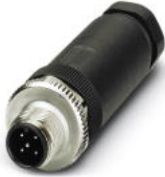
Sensor-/Aktor-Stecker, Stecker, gerade, 5-polig, M12, A-kodiert, Schraubanschluss, Metallrändel, Kabelverschraubung Pg9
