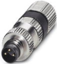
Sensor-/Aktor-Stecker, Stecker, gerade, 3-polig, M8, Piercecon®, Metallrändel, Kabeldurchmesser max. 5 mm
