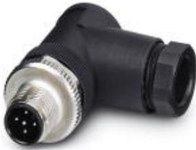
Sensor-/Aktor-Stecker, Stecker, gewinkelt, 5-polig, M12, A-kodiert, Schraubanschluss, Metallrändel, Kabelverschraubung Pg9
