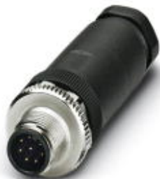
Sensor-/Aktor-Stecker, Stecker, gerade, 8-polig, M12, A-kodiert, Schraubanschluss, Metallrändel, Kabelverschraubung Pg9
