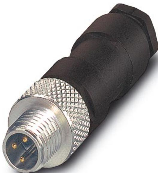
Sensor-/Aktor-Stecker, Stecker, gerade, 3-polig, M8, Schraubanschluss, Metallrändel, Kabeldurchmesser max. 5 mm
