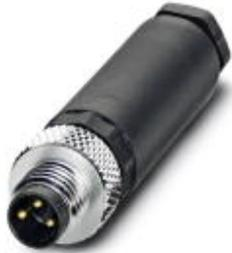
Steckverbinder, 3-polig, Stecker gerade M8, A-kodiert, Schraubanschluss, Rändelmaterial: Messing, vernickelt, Kabelaußendurchmesser 3,5 mm ... 5 mm
