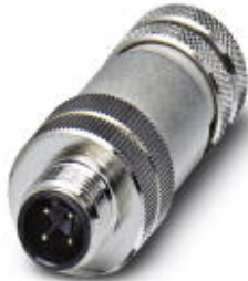
Sensor-/Aktor-Stecker, Stecker, gerade, 4-polig, M12 geschirmt, A-kodiert, Schraubanschluss, Metallrändel, Kabelverschraubung Pg7
