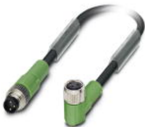
Sensor-/Aktor-Kabel, 3-polig, PUR halogenfrei, schwarzgrau RAL 7021, Stecker gerade M8, auf Buchse gewinkelt M8, Kabellänge: 1,5 m
