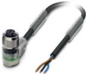
Sensor-/Aktor-Kabel, 3-polig, PUR halogenfrei, schwarzgrau RAL 7021, freies Leitungsende, auf Buchse gewinkelt M12, A-kodiert, mit 2 LEDs, Kabellänge: 5 m
