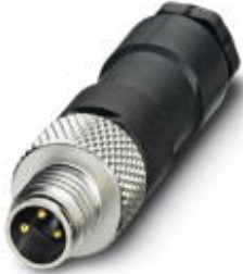
Sensor-/Aktor-Stecker, Stecker, gerade, 3-polig, M8, Lötanschluss, Metallrändel, Kabeldurchmesser max. 5 mm
