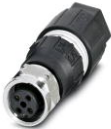
Sensor-/Aktor-Steckverbinder, Universal, 4-polig, Stecker gerade M12, A-kodiert, Schneidklemmanschluss, Rändelmaterial: Edelstahl, Kabelaußendurchmesser 4 mm ... 8 mm
