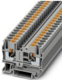
Durchgangsklemme, Anschlussart: Push-in-Anschluss, Querschnitt: 0,5 mm 2 - 10 mm 2 , AWG: 20 - 8, Breite: 8,2 mm, Höhe: 42,2 mm, Farbe: grau, Montageart: NS 35/7,5, NS 35/15
