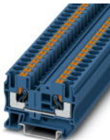
Durchgangsklemme, Anschlussart: Push-in-Anschluss, Querschnitt: 0,5 mm 2 - 10 mm 2 , AWG: 20 - 8, Breite: 8,2 mm, Höhe: 42,2 mm, Farbe: blau, Montageart: NS 35/7,5, NS 35/15
