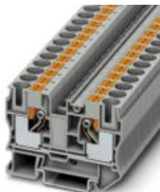
Durchgangsklemme, Anschlussart: Push-in-Anschluss, Querschnitt: 0,5 mm 2 - 16 mm 2 , AWG: 20 - 6, Breite: 10,2 mm, Höhe: 49,5 mm, Farbe: grau, Montageart: NS 35/7,5, NS 35/15
