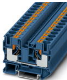
Durchgangsklemme, Anschlussart: Push-in-Anschluss, Querschnitt: 0,5 mm 2 - 16 mm 2 , AWG: 20 - 6, Breite: 10,2 mm, Höhe: 49,5 mm, Farbe: blau, Montageart: NS 35/7,5, NS 35/15
