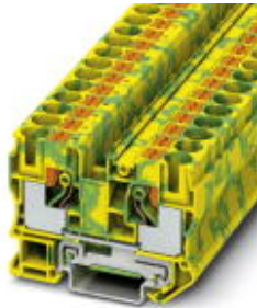
Schutzleiter-Reihenklemme, Anschlussart: Push-in-Anschluss, Querschnitt: 0,5 mm 2 - 16 mm 2 , AWG: 20 - 6, Breite: 10,2 mm, Höhe: 49,5 mm, Farbe: grün-gelb, Montageart: NS 35/7,5, NS 35/15
