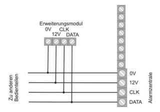
Beachten Sie beim Anschluss des 8-Zonen Drahterweiterungs-moduls, dass der Zonenabschluss (NC / DEOL) von Zentrale und Erweiterungsmodul identisch ist.
