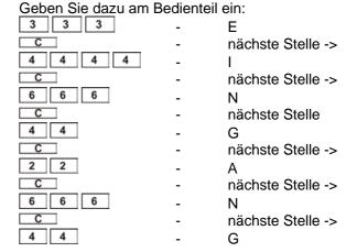
6. Haben Sie sich vertippt, können Sie mit der D-Taste D den Cursor zurück bewegen. 7. Einen Buchstaben oder eine Ziffer löschen Sie, indem Sie an diese Position ein Leerzeichen mit Hilfe der 0-Taste setzen.
