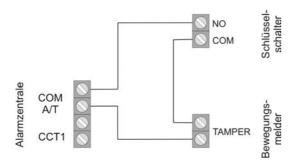
Wenn Sie ausschließlich Melder ohne Sabotagekontakt verwenden, müssen Sie eine Brücke zwischen COM und A/T an dem Alarmsystem einfügen
