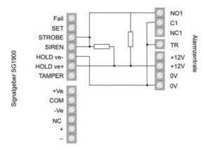
Verwenden Sie zum Anschluss der SG1900 die beigefügten Widerstände (1k Ohm). Vergessen Sie nicht den Anschluss des internen Akkus von NC auf Battery (–) umzuklemmen.
