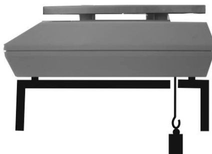
Abb. 1: Einrichten der Waage für Unterflurwägungen
