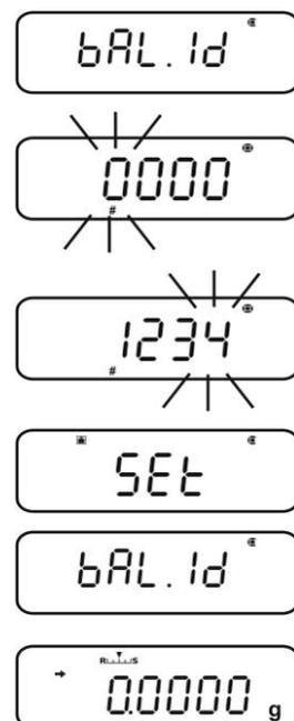
⇒ **ON/OFF** wiederholt oder 3 s lang drücken, die Waage kehrt zurück in den Wägemodus
