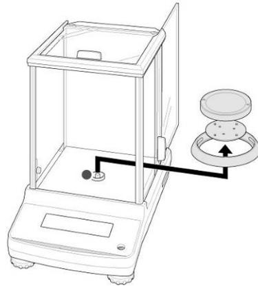
2. Plastikgriff durch Drehen entfernen.
