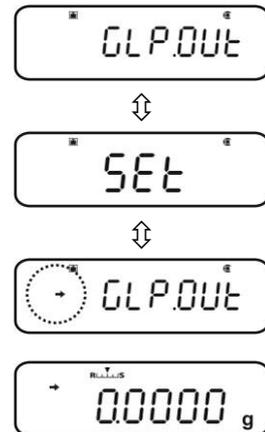
⇒ **ON/OFF** wiederholt oder 3 s lang drücken, die Waage kehrt zurück in den Wägemodus
