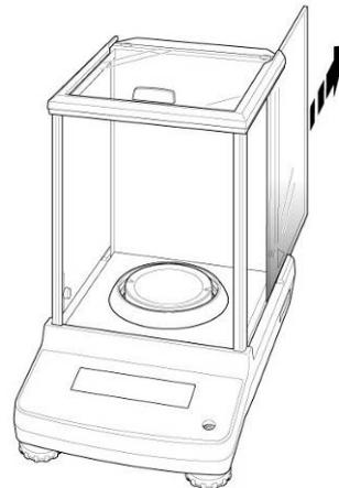
Abb. 2: Glastüren entfernen
