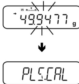
Wageplatte entlasten. Die Grammanzeige blinkt erneut 2 Min. lang. Danach wird die interne Justierung automatisch gestartet. Um den korrekten PSC-Betrieb zu gewahrleisten, mussen Vibrationen und Luftstrome vermieden werden.
