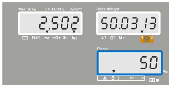
Bei Anschluss eines optionalen Druckers kann der Anzeigenwert durch Drücken von
