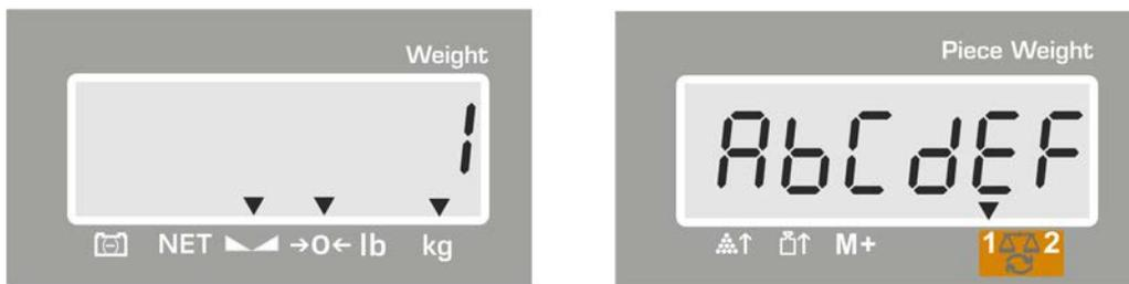
⇒ Eingabe mit **TARE** bestätigen. Die Daten (Tarawert, durchschnittliches Stückgewicht, Artikelbezeichnung) werden unter der ausgewählten Direkttaste gespeichert.
