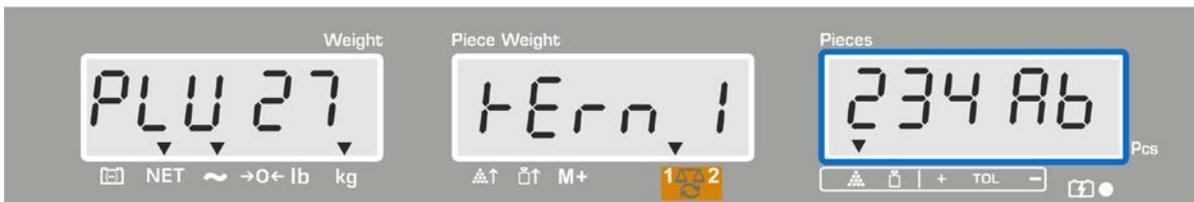
Die Anzeige wechselt in den Zählmodus, der hinterlegte Tarawert z. B. 500 g und das durchschnittliche Stückgewicht z. B 10g /Stck. werden angezeigt.
