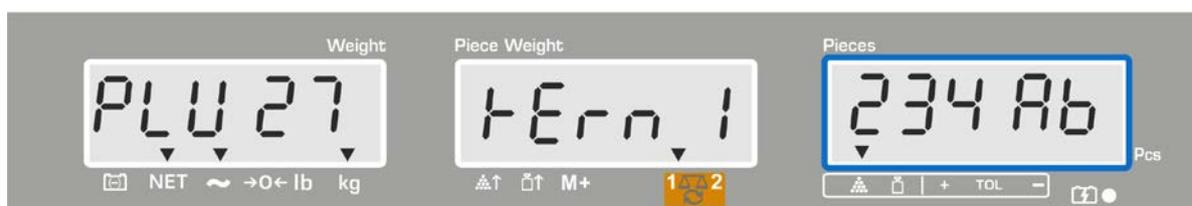
⇒ Eingabe mit
