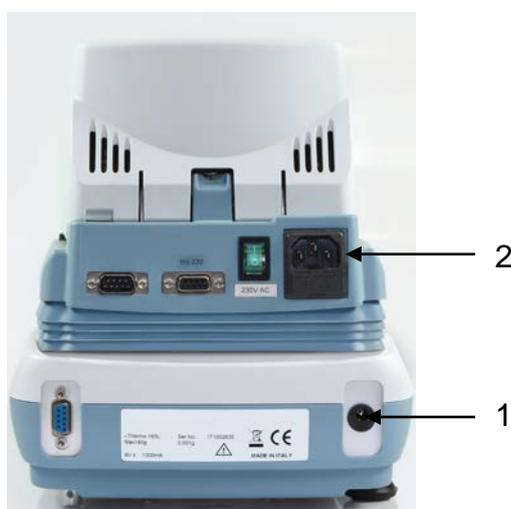
1. Die Stromversorgung der Waage erfolgt über das externe Netzgerät. Der aufgedruckte Spannungswert muss mit der örtlichen Spannung übereinstimmen. Verwenden Sie nur KERN- Originalnetzgeräte. Die Verwendung anderer Fabrikate bedarf der Zustimmung von KERN.
