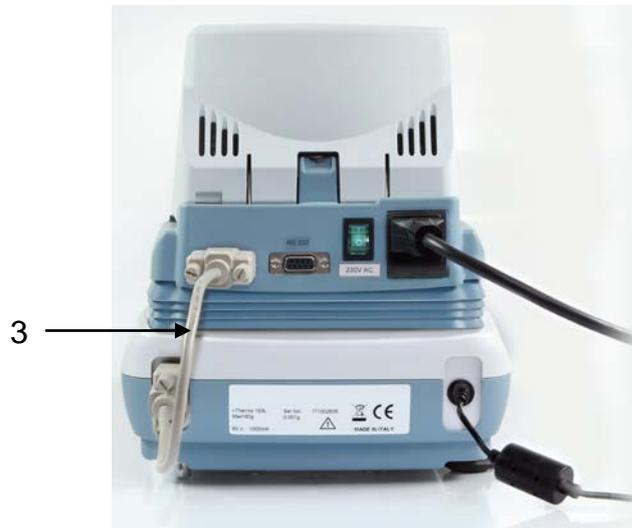
Das Gerät darf nur an eine vorschriftsmäßig installierte Steckdose mit Schutzleiteranschluss (PE) angeschlossen werden. Die Schutzwirkung darf nicht mit einer Verlängerungsleitung ohne Schutzleiter aufgehoben werden. Bei Spannungsversorgung aus Netzen ohne Schutzleiteranschluss ist von einem Fachmann ein gleichwertiger Schutz entsprechend den gültigen Installationsvorschriften herzustellen.
