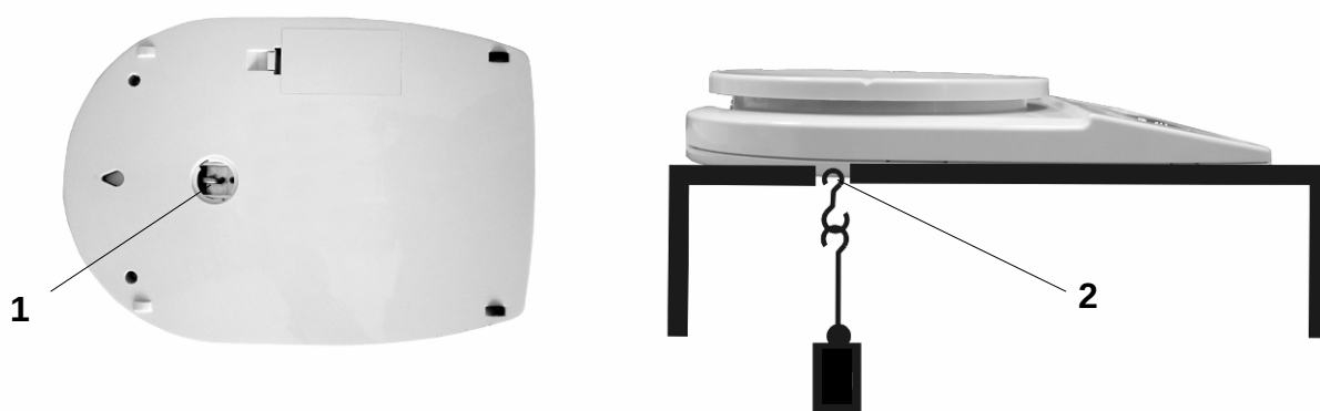
Abb. 1: Einrichten der Waage für Unterflurwägungen
