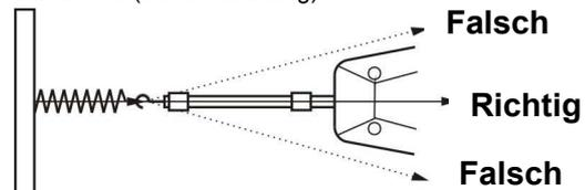
\* Messgerät niemals über die angegebene Höchstlast hinaus belasten (!!Bruchgefahr!!).
