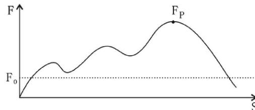
Diese Funktion wird bei solchen Messungen eingesetzt, bei denen unerwünschte „Vor-Peaks“ auftreten, die unterhalb des gesuchten Peak-Wertes ( $F_P$ ) liegen. Der einstellbare Grenzwert ( $F_0$ ) verhindert, dass das Messgerät die „Vor-Peaks“ abspeichert. Mindestgrenzwertfunktion ist nur im „Peak Modus“ möglich
