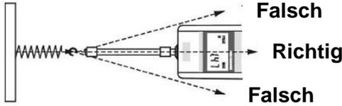
Messgerät niemals über die angegebene Höchstlast hinaus belasten (!!Bruchgefahr!!).
