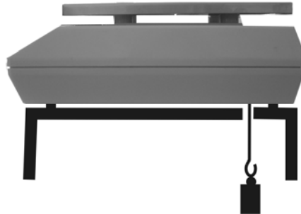
Abb. 1: Einrichten der Waage für Unterflurwägungen
