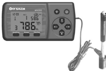
Das Signalkabel wird mit dem Rückprallsensor verbunden.
