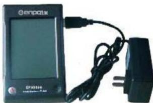
Daraufhin wird das Ladegerät mit der AC- Buchse (220V/ 50Hz) verbunden, um den Ladevorgang zu starten. Auf dem Bildschirm ist „charging“ abzulesen (s. Abb. 4-40)
