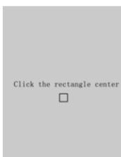
Das Innere wird mit dem Touch Pen angeklickt und das System kehrt automatisch zum Fenster der Kalibrierung zurück. Somit ist die Touch Kalibrierung abgeschlossen.
