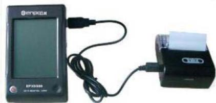
Der Drucker wird nun durch Betätigen der Einschalttaste gestartet. Darauf wird der Härtestester wieder eingeschaltet. Weitere Funktionen wie z. B. das Aufladen, sind in der Bedienungsanleitung des Minidruckers nachzulesen.
