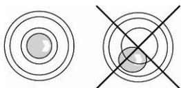
Waage mit Fußschrauben nivellieren, bis sich die Luftblase in der Libelle im vorgeschriebenen Kreis befindet.
