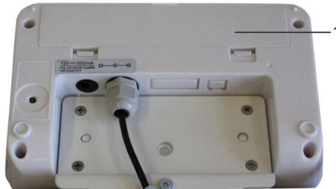
Akkufachdeckel (1) an der Unterseite des Anzeigerätes öffnen und Akkupack anschließen. Der Akku sollte vor der ersten Benutzung mindestens 12 Stunden geladen werden.
