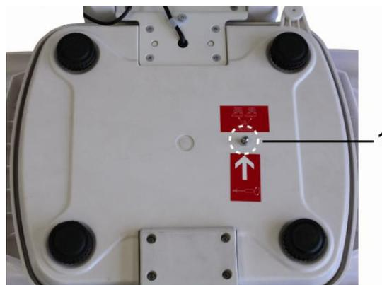
Zum Lösen der Transportsicherung Transportschraube [1] gegen den Uhrzeigersinn herausdrehen.
