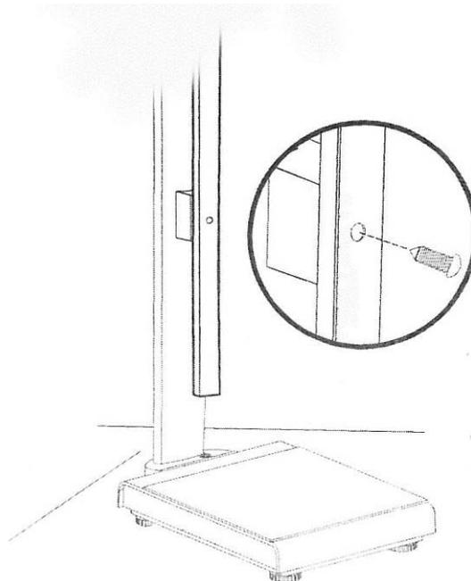
Größenmessstab ausziehen und am Halter mit der dazugehörigen Schraube am unteren Loch festschrauben.
