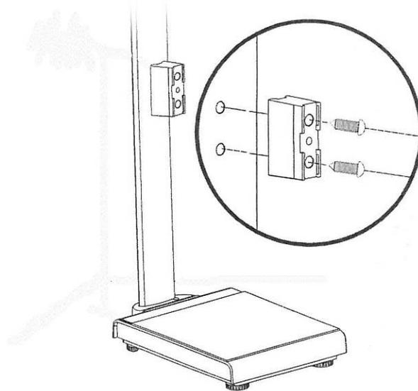
Halter mit 2 Schrauben am Stativ der Waage in die vorhandenen Gewindebuchsen einschrauben.
