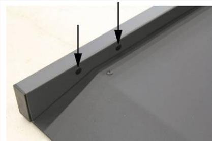
Kunststoffabdeckungen an der Waage vorsichtig entfernen, darauf achten, dass die Waage nicht zerkratzt wird.
