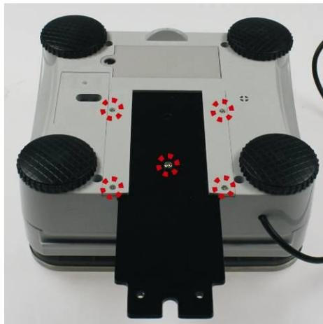
Zum Demontieren Montageblech durch Lösen der markierten Schrauben entfernen. Danach kann das Anzeigergerät frei aufgestellt werden.
