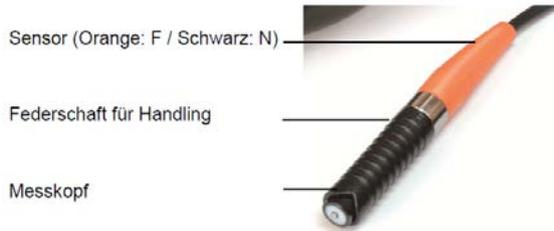
Der Sensor ist am unteren Schaftsegment anzufassen und wird nur leicht auf das Prüfobjekt angedrückt. Das schwarze, geriffelte Schaftsegment ist auf einer Feder beweglich gelagert. Durch die Feder drückt der Sensorkopf mit einer definierten Kraft auf das Prüfobjekt und vermeidet dadurch Messfehler.
