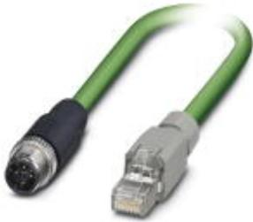
Konfektioniertes PROFINET-Kabel, CAT5e, geschirmt, Sternvierer, AWG 22 flexibel (7-drätig), RAL 6018 (gelbgrün), M12-Stecker auf RJ45-Stecker/IP20, Line, Länge 3 m
