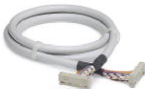
Konfektioniertes Rundkabel, mit zwei 16-poligen Federleisten (1:1 Verbindung), Kabellänge: 2 m
