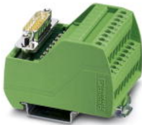
VARIOFACE-Modul, mit Schraubanschluss und D-SUB-Miniatur-Stiftleiste, zur Montage auf NS 35-Tragschienen, mit LED, Polzahl: 15
