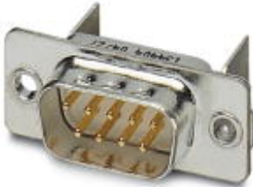
D-SUB-Kontakteinsatz, Shell-Größe 1, mit 9 Signalkontakten, Kontaktart Stift, für Leiterplattenmontage, abgewinkelt, Befestigung mittels Bohrung 2,5 mm und Lötblech, für Anbraurahmen VS-09-...
