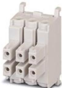
Kontakteinsatz-Modul, für Tüllenrahmen, mit Schraubanschluss, 5-polig + PE-Anschluss, 250 V / 10 A
