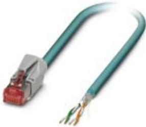
Konfektioniertes Ethernet-Kabel, CAT5e, geschirmt, 2-paarig, AWG 26 flexibel (7-drähtig), RAL 5021 (wasserblau), RJ45-Stecker/IP20 auf freies Leitungsende, Line, Länge 2 m
