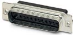
D-SUB-Kontaktträger, Shell-Größe 3, für 25 Signalkontakte, Kontaktart Stift, für Crimpkontakte, gerade, Befestigung mittels Gewinde 4-40 UNC, für Anbaurahmen VS-25-...
