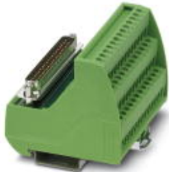
VARIOFACE-Modul, mit Schraubanschluss und D-SUB-Miniatur-Stiftleiste, zur Montage auf NS 35-Tragschienen, Polzahl: 37
