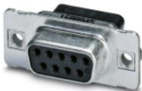
D-SUB-Kontaktträger, Shell-Größe 1, für 9 Signalkontakte, Kontaktart Buchse, für Crimpkontakte, gerade, Befestigung mittels Gewinde 4-40 UNC, für Anbaurahmen VS-09-...
