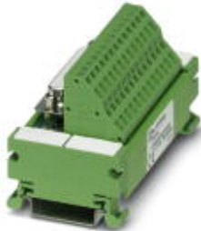
VARIOFACE-Modul, mit Zugfederanschluss und D-Subminiatur-Buchsenleiste, zur Montage auf NS 35/7,5, Polzahl 25
