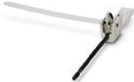
Schirmschnellanschluss für Leitungsdurchmesser 5 - 10 mm. Potenzialanschlussleitung: 200 mm, schwarz
