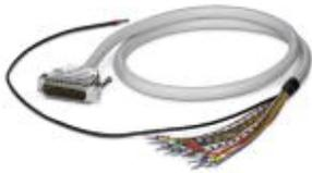
Geschirmtes Kabel mit einer 37-poligen D-SUB-Stiftleiste und einem offenem Ende. Die Einzeladern sind von 1 bis 37 beschriftet und mit Aderendhülsen versehen. Das Schirmgeflecht ist auf ein separates Kabelende heraus geführt. Kabellänge: 1 m
